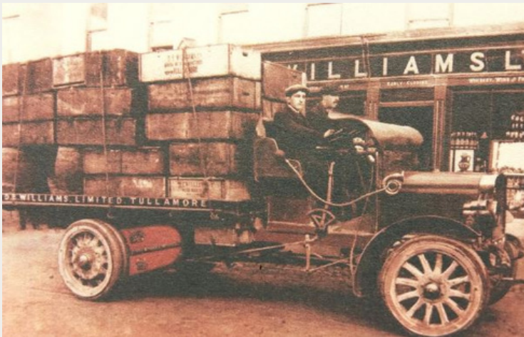
D.E. Williams Teo. agus a gcéad mhótar-leoraí IR 164 a cláraíodh ar an 25 Márta 1913. "Commer lorry 25 hp", dath dearg, 2 1/2 tonna.
